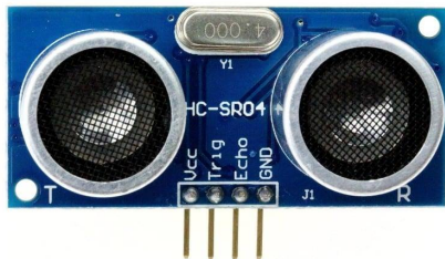
Fig. 4 Ultrasonic sensor module
